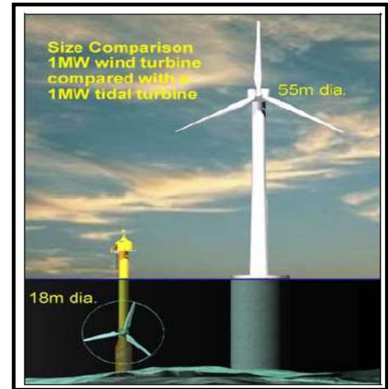
Figura 17. Comparação das Turbinas Corrente de Maré e Eólica
